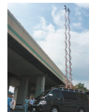
橋梁トンネル点検用 (高速道路会社)
