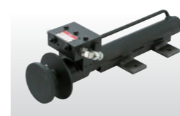
車体安定ジャッキシリンダ 車両の揺れを防ぎ安定させるための油圧駆動のジャッキシリンダ。車種に合わせてサイズとストロークを選択できます。車体の後方2本取付または前後4本取付の仕様があります。
